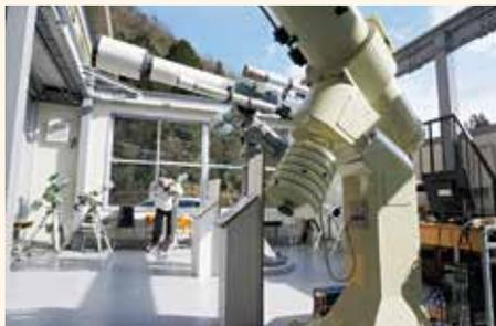
観測施設の大型望遠鏡
